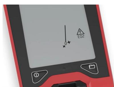
En cas d'apparition du pictogramme ci-contre sur l'écran : le récepteur de la micro cuvette doit être nettoyé.
